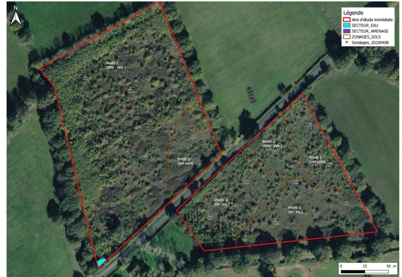
Figure 27 : Localisation des points de sondages pédologiques et délimitation des différents profils de sols
